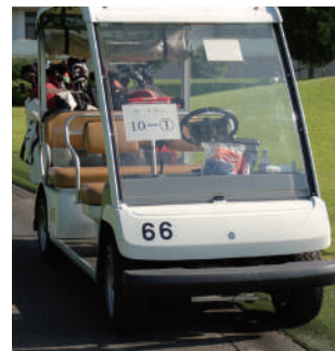
電磁誘導カート
